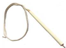
Termopara drutowa (kl.2) Max temp. (K): 1000°C Część robocza: 100 lub 200mm Długość całkowita: 1m lub więcej Otwarta spoina pomiarowa
