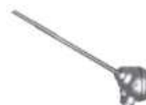
Termopara z głowicą Płaszcz inconel (K): 1100°C Płaszcz inconel-tytan (K): 1200°C Płaszcz ceramika (S): 1300°C Część robocza: 200mm lub inna. Hermetyczna głowica przyłączeniowa.
