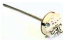
Termopara do zabudowy Płaszcz inconel (K): 1100°C Płaszcz inconel-tytan (K): 1200°C Płaszcz ceramika (S): 1300°C Część robocza: 200mm lub inna
